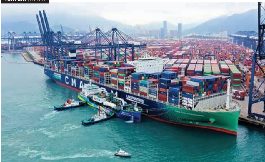
Un nuevo buque bunker de GNL de 8.500 metros cúbicos suministró GNL al M/V CMA CGM SORBONNE mediante transferencia de barco a barco
